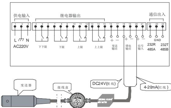
最多利用两个液位变送器与 MSB9438 二次仪表组成一个多路显示的液位差计，并能够分别输出 4mA ~ 20mADC 模拟量，提供上下限控制报警和控制接点。
