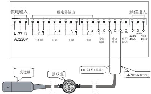
与 MSB9418 二次仪表连接成一个具有上下限控制报警的液位测控系统，并且二次仪表可输出 RS232 或模拟信号 1V ~ 5VDC、0V ~ 5VDC、4mA ~ 20mADC。
