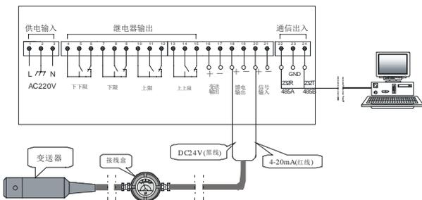
防爆型变送器与安全栅及二次仪表配接成测量控制系统。
